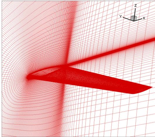
加密后 M6 机翼网格，网格单元总数 2359300。
