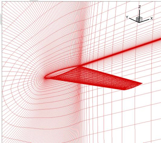
加密前 M6 机翼网格，网格单元总数 294912。
