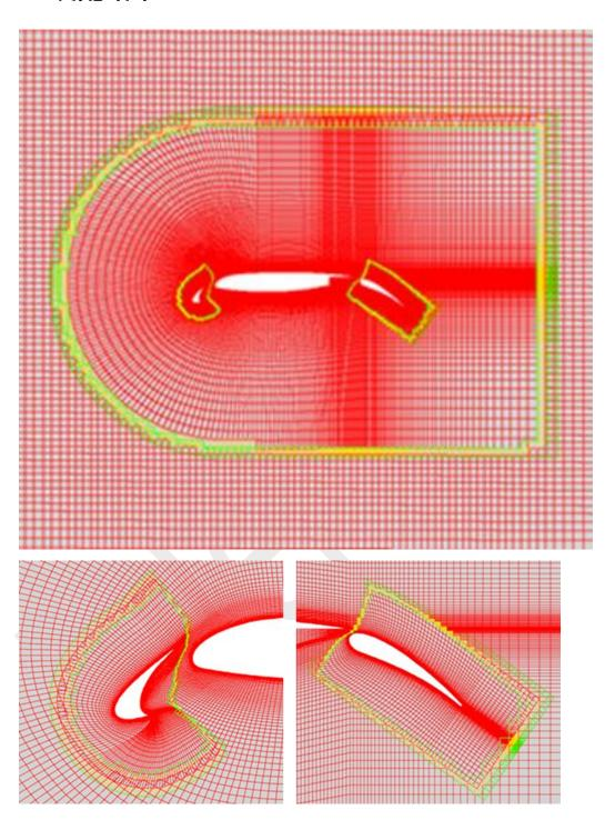
打开 tecflow0\_0.plt 文件查看装配结果,图内绿色部分 iblank=1 为重叠边界,红色部分 iblank=2 为计算单元,蓝色 iblank=0 的无效单元已挖去。
