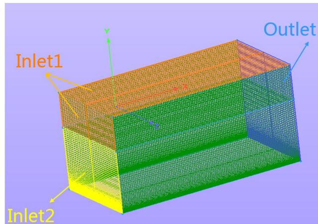
边界条件包括两个入口边界 Inlet1（自定义入口边界）和 Inlet2、出口边界、固壁边界及对称边界。
