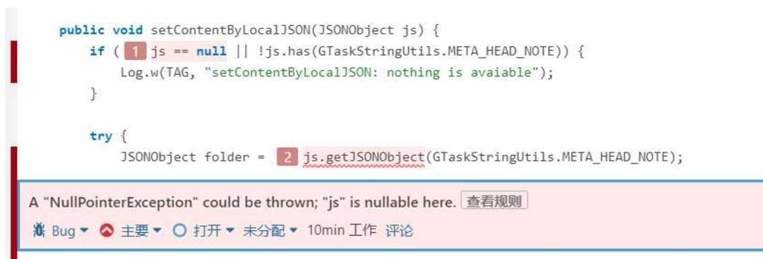
图 33 工具分析漏洞，主要问题
