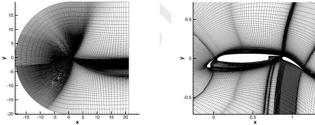
图1 网格空间拓扑示意图及局部放大图
