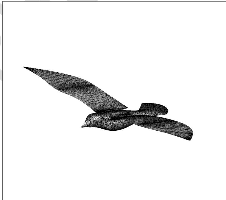
算例网格采用非结构 bird 网格，约 14W 网格单元
